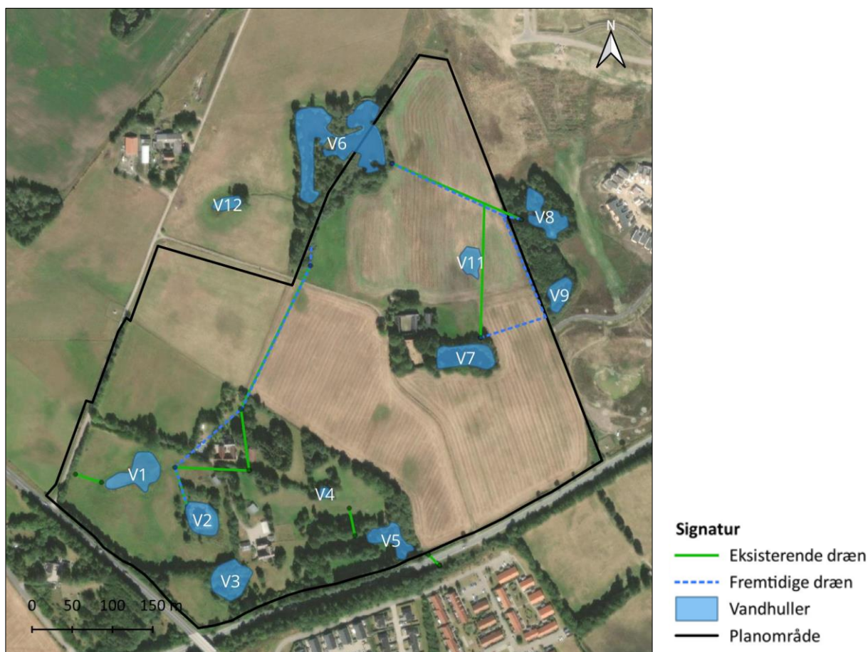
Figur 9-3: Princip for nyt drænsystem.
