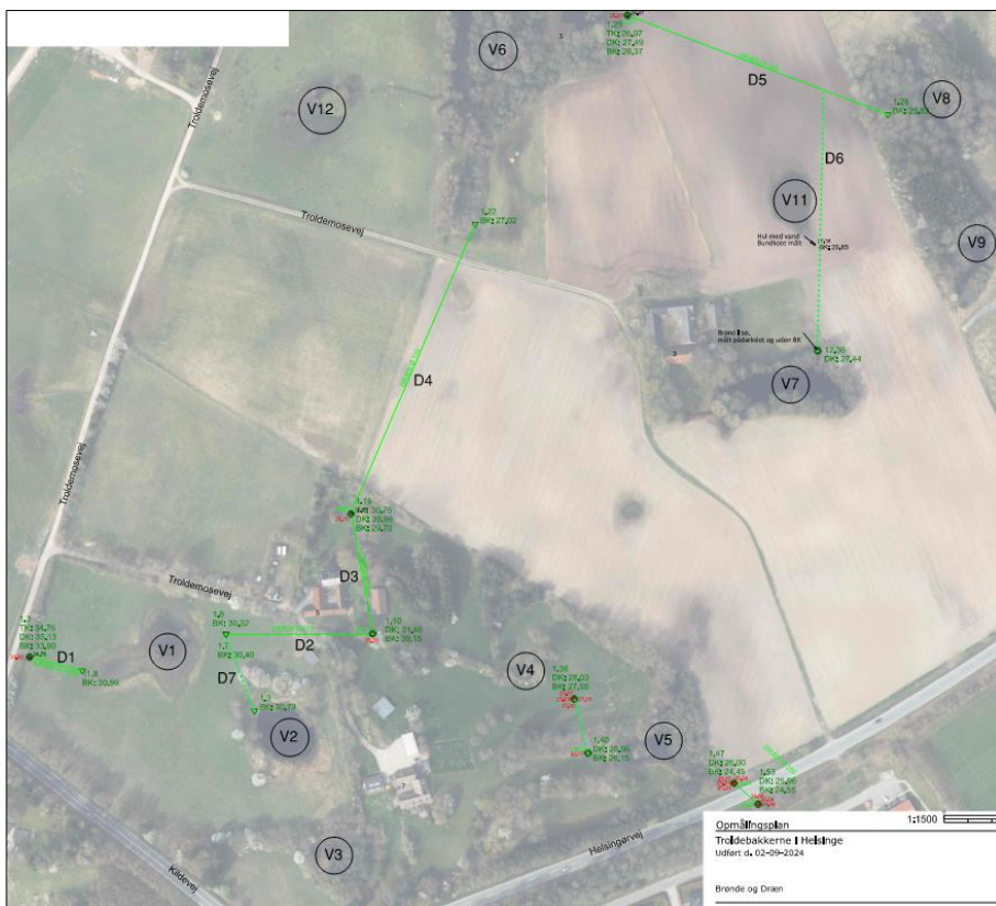
Figur 9-2: Eksisterende dræn. LE34. Navne på vandhuller og dræn påtegnet efterfølgende.
